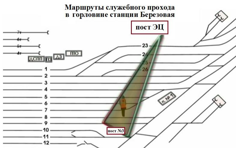
Рис.3 Визуальный контроль во время работы маневрового диспетчера
