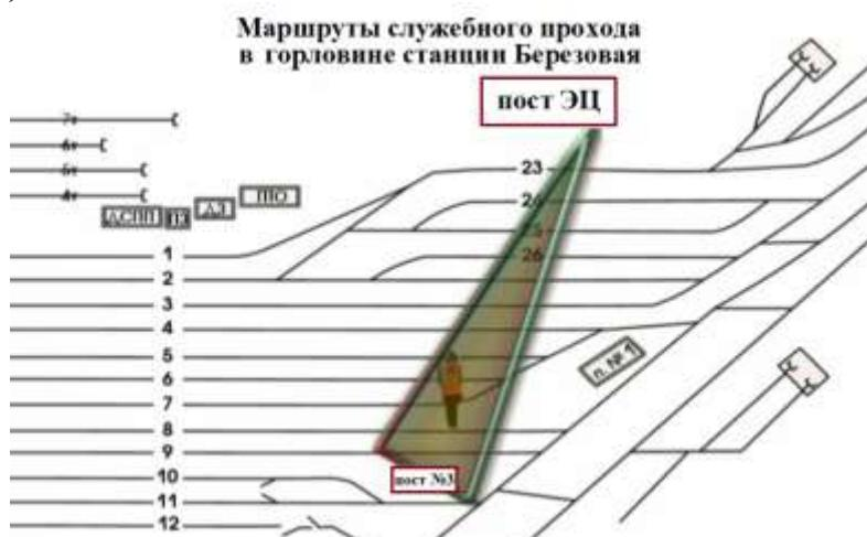
Рис.3 Визуальный контроль во время работы маневрового диспетчера
