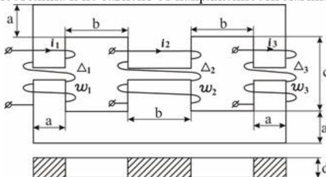
Геометрические размеры магнитопровода указаны на рисунке. Конкретный расчётный вариант, выбирается в соответствие с буквенной литерой. Конструкция включает две обмотки, по одной из которых протекает электрический ток. Один из трёх стержней магнитопровода имеет воздушный зазор. Для всех вариантов величина тока определяется по формуле:  $i = 1 + 0,1 (n/m)$  А.
