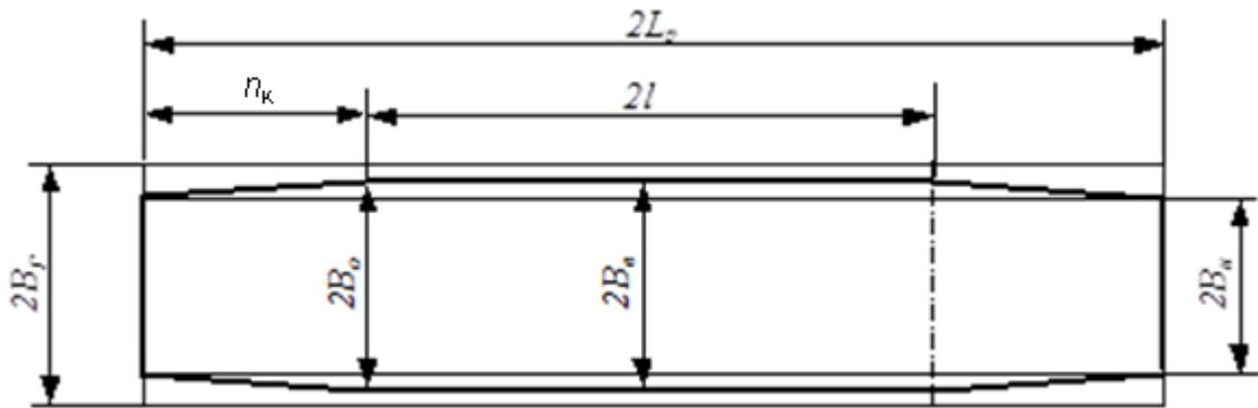
Расстояние от основного поперечного сечения до наружного (длина консольной части вагона)
