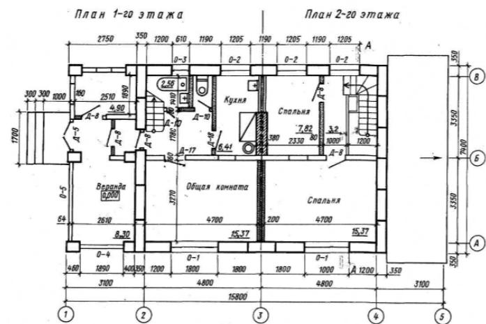
Рис. 3. Пример выполнения плана крупноблочного жилого дома
