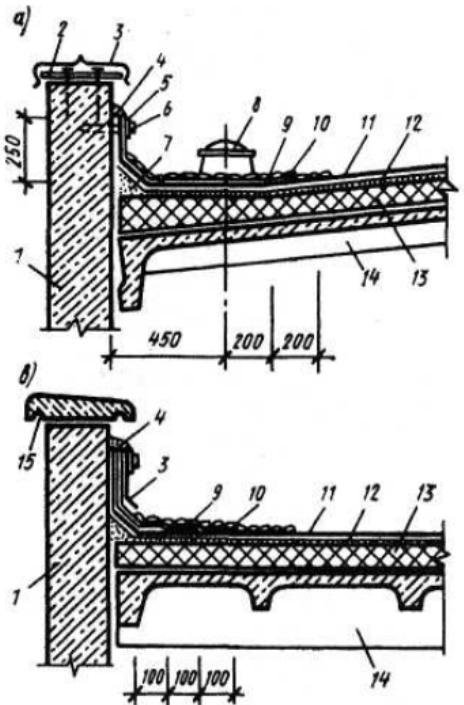
Рис. 16. Детали примыкания кровли к парапету:
