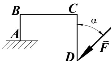
Найти длину балки AO, если при действии на нее силы  $F=800\text{Н}$  под углом  $\alpha = 30^\circ$  к горизонтали момента в заделке O равен  $200\text{Нм}$ .
