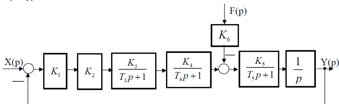
**Задание №3** Преобразовать (свернуть) структурную схему САУ и получить передаточные функции замкнутой и разомкнутой САУ по управляющему и возмущающему воздействиям, а также общую
