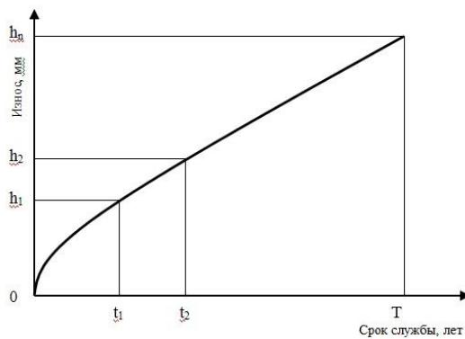
Рис. 5. Типовая схема прогнозирования долговечности деталей и узлов
