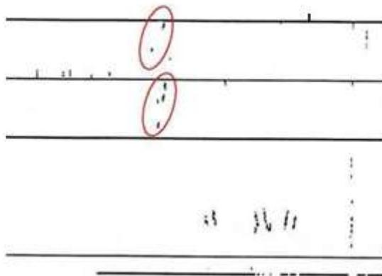
Рис. Дефектограммы изломов рельсов - излом рельса(код дефекта 21.2) по поперечной трещине в головке рельса
