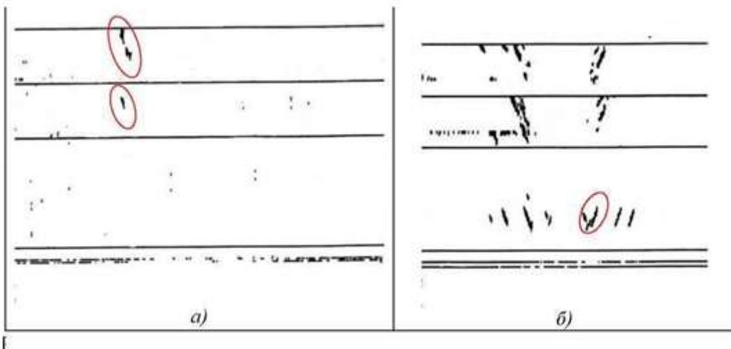
а - поперечная трещина в головке рельса (код 21.2);
