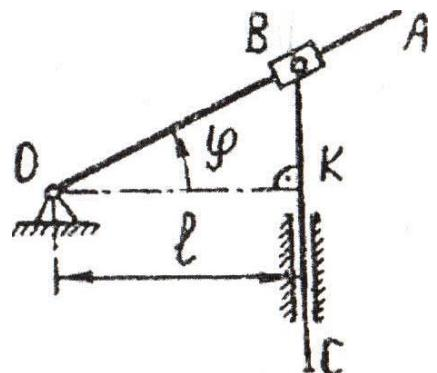
в движение стержень  $BC$ . Определить скорость движения ползуна  $B$  относительно кривошипа в функции угловой скорости  $w$  и угла поворота  $\varphi$  кривошипа.
