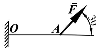
Стержень ОА, находится в вертикальной плоскости, шарнирно закреплен в точке О. Определить модуль горизонтальной силы  $\vec{F}$  при которой стержень находится в равновесии, если угол  $\alpha = 45^\circ$  вес стержня  $G = 5$ Н приложен посередине стержня  $OC=CA$ .
