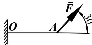
Стержень ОА, находится в вертикальной плоскости, шарнирно закреплен в точке О. Определить модуль горизонтальной силы  $\bar{F}$  при которой стержень находится в равновесии, если угол  $\alpha = 45^\circ$  вес стержня  $G = 5\text{Н}$  приложен посередине стержня ОС=СА.
