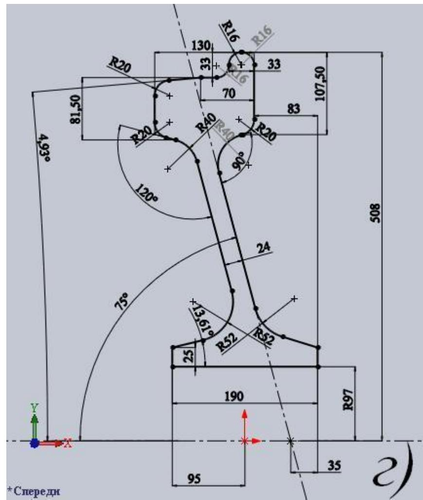
**Задание 2.** Разработать модель среднего листа цистерны в SolidWorks с параметрическим заданием размеров, используя инструмент «Уравнения» (этапы разработки модели, представленные рисунками и расположенные в произвольном порядке, прилагаются)
