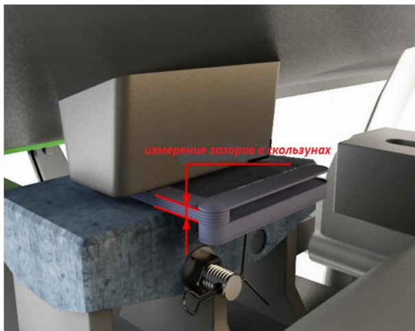
Измерение зазора между скользунами
