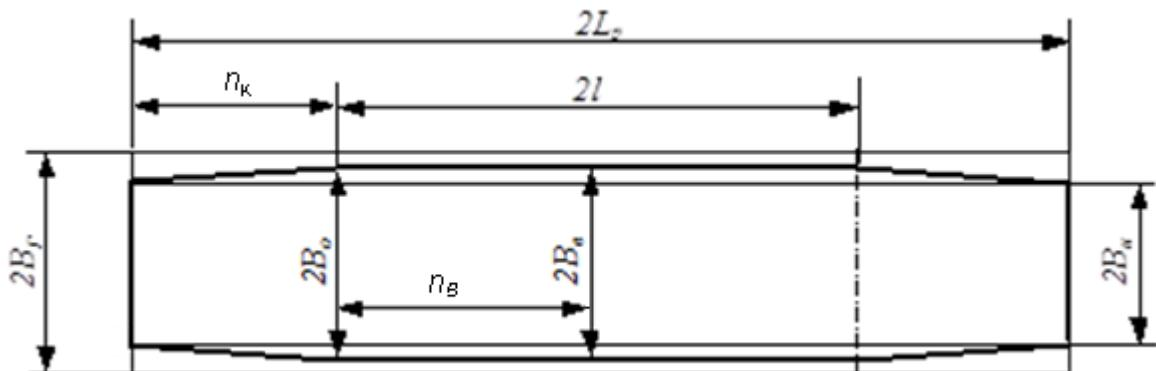
Расстояние от основного поперечного сечения до внутреннего определяется по формуле  $n_B = \frac{2l}{2}$
