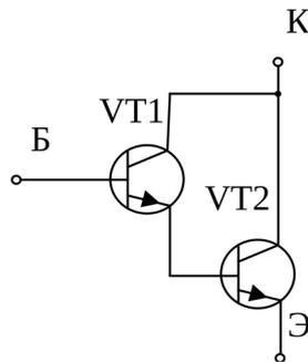
Задача 3. Для транзистора ГТ109А коэффициент передачи тока эмиттера  $h_{21Б} = 0,95...0,98$ . Определить, в каких пределах может изменяться коэффициент усиления тока базы.
