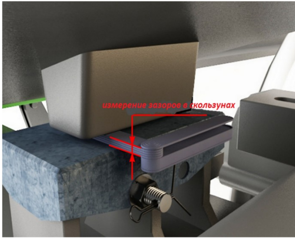
Измерение зазора между скользянами
