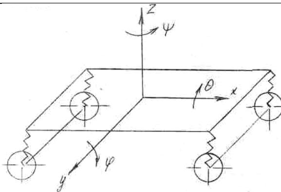
Определить поступательное линейное перемещение наддрессорного строения вагона в направлении оси  $Z$ .
