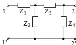
7. Определить матрицу передаточной проводимости рельсовой цепи в контрольном режиме в соответствии со схемой с использованием математических пакетов (программного обеспечения):
