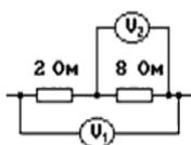
Показания первого вольтметра  $V_1$  равно 20 В. Что показывает второй вольтметр  $V_2$ ?
