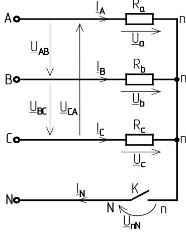
Произведите измерения фазных токов  $I_A, I_B, I_C$ ; фазных напряжений приемника  $U_a, U_b, U_c$  и системы линейных напряжений  $U_{AB}, U_{BC}, U_{CA}$ .
