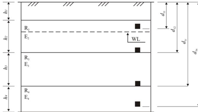
Рис. 1. Схема к определению расчетного сопротивления грунта
