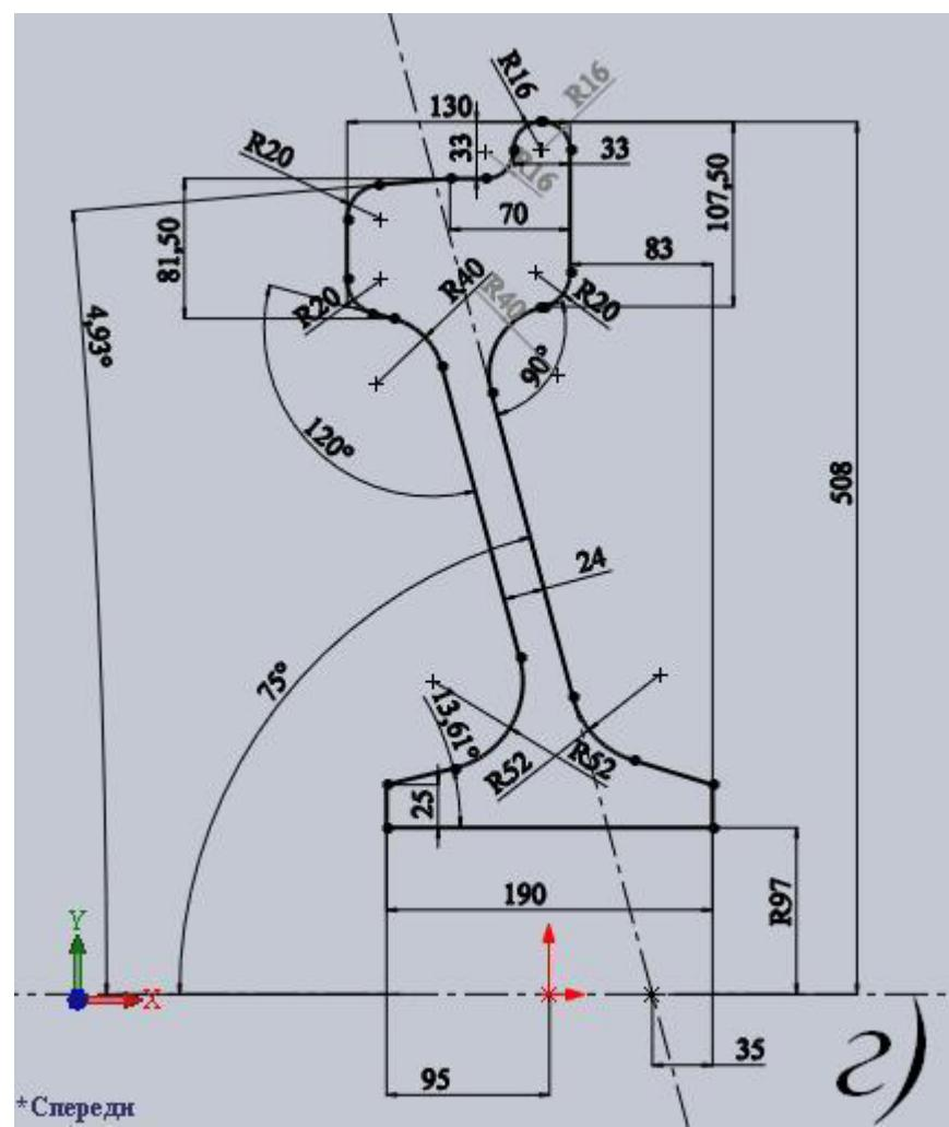
**Задание 2.** Разработать модель среднего листа котла цистерны в SolidWorks с параметрическим заданием размеров, используя инструмент «Уравнения» (этапы разработки модели, представленные рисунками и расположенные в произвольном порядке, прилагаются)
