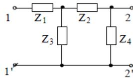
6. Определить матрицу передаточного сопротивления рельсовой цепи в контрольном режиме в соответствии со схемой с использованием математических пакетов (программного обеспечения):
