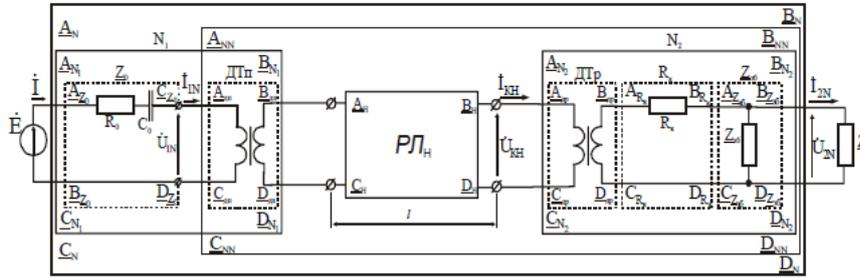
7. Определить матрицу передаточной проводимости рельсовой цепи в контрольном режиме в соответствии со схемой с использованием математических пакетов (программного обеспечения):
