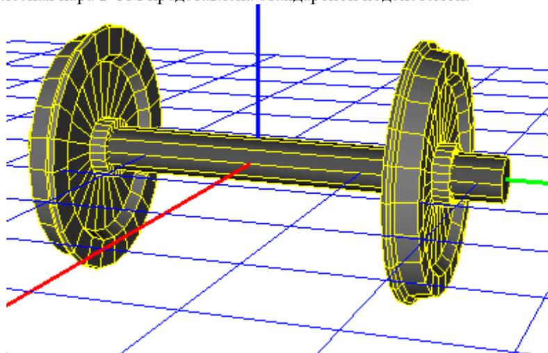
Колесная пара – одна из стандартных подсистем «Универсальный механизм». Для добавления новой колесной пары откройте окно инспектора моделирования объекта. Для этого выберите пункт меню Анализ/Моделирование.
