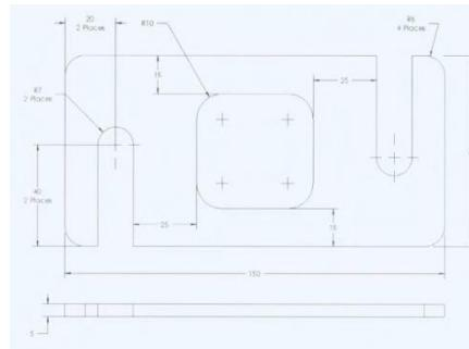
5.3. Создайте деталь, используя следующее графическое изображение, которое соответствует замыслу проекта. Отверстия концентричны круговым кромкам, созданным скруглениям. Все отверстия являются сквозными.
