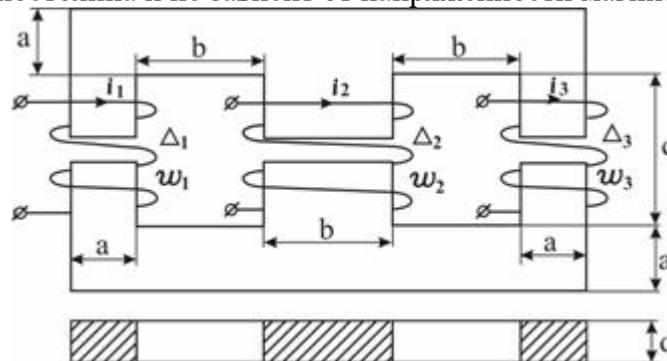
Геометрические размеры магнитопровода указаны на рисунке. Конкретный расчётный вариант, выбирается в соответствие с буквенной литерой. Конструкция включает две обмотки, по одной из которых протекает электрический ток. Один из трёх стержней магнитопровода имеет воздушный зазор. Для всех вариантов величина тока определяется по формуле:  $i = 1 + 0,1$  (н/м) А.
