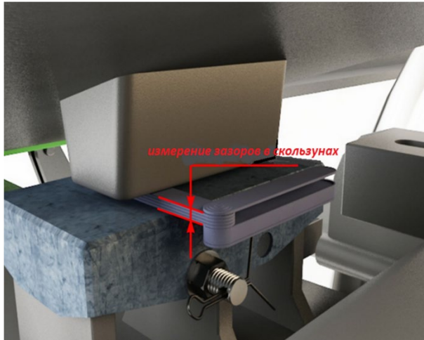
Измерение зазора между скользунами
