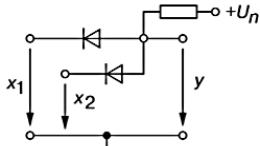
7. Определите и напишите формулу логической функции, которая реализуется схемотехническим решением
