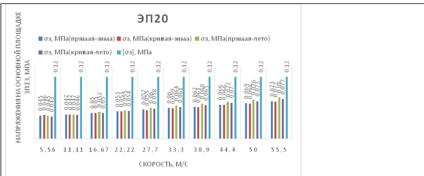
По приведенному графику сделать анализ изменения напряжений на основной площадке земляного полотна
